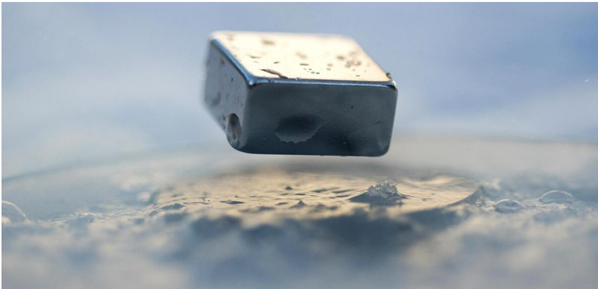
Lévitation d'un aimant placé au-dessus d'une pastille de matériau supraconducteur refroidi dans de l'azote liquide à - 196 °C. Crédits: CNRS LE JOURNAL
