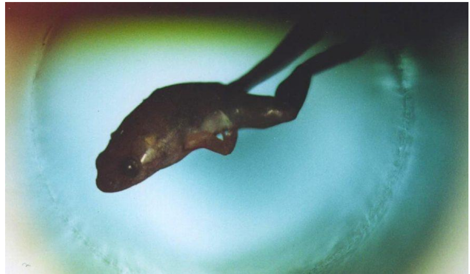
Une grenouille en lévitation diamagnétique
